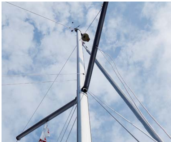
"Kispus" har en original brøkdelsrig med en enkelt saling og masteprofil fra Isomat.
