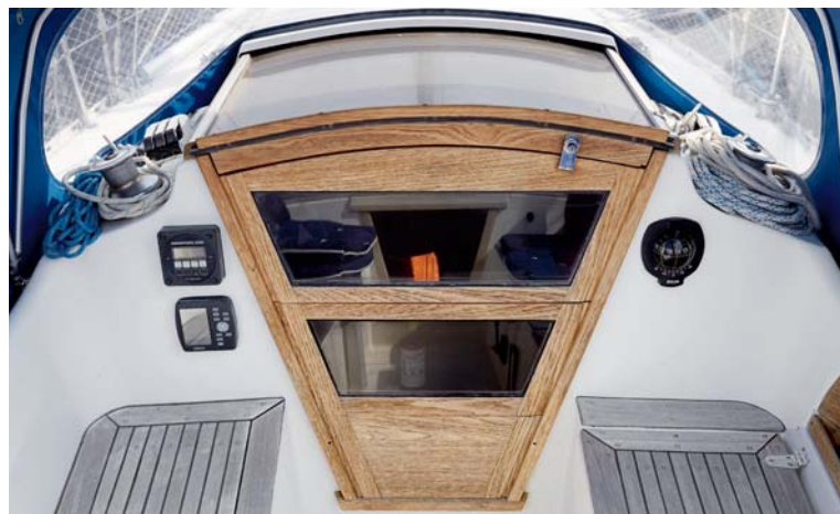
Skydekappen er ny og teaktræet er hvert år behandlet med teakolie. Båden har Lewmar fald- og skødespil. Nyere Spinlock spilaflastere og mere gammeldags manuelle jammers til fald og trimliner.
